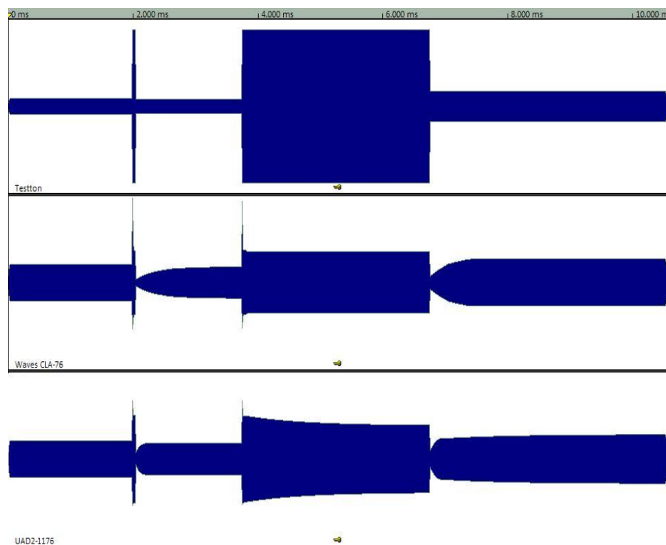
Abbildung 8. Attack- und Releasezeit Messung bei 44.1kHz Abtastrate
